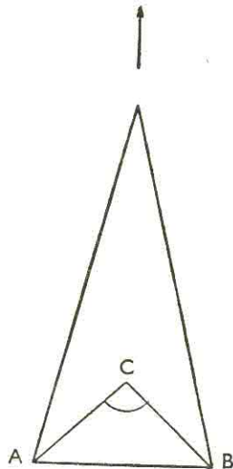
Fig. 2. Dispositivo che conduce all'intuizione della proprietà della somma degli angoli di un triangolo.
